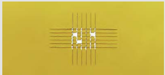
ISO等级：3 / ASTM等级：2B 切口边缘有部分或大片剥落，或者部分格子被整片剥落。其面积大于15%，但不足30%
