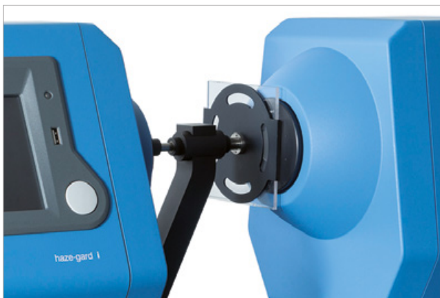
雾影的测量用来决定透明材料的抗磨损能力，用雾影支架附件可把磨损区域置于测量光束中。
